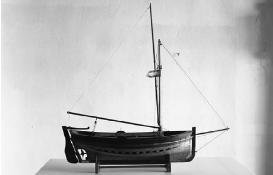
Model de bot cobertat amb un pal a proa i botaló, du aparell guairo. Mestre Guillem Amengual
