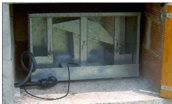
Fotografia 27 - Balanci de mesura de l'escolament.
