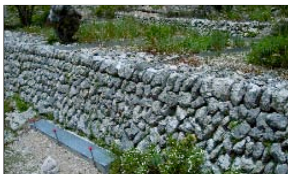
Fotografia 25 - Parcel·la experimental per mesurar l'escolament a la base del marge.
