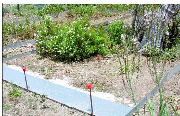
Fotografia 26 - Parcel·la experimental per mesurar l'escolament a la part alta de la marjada.
